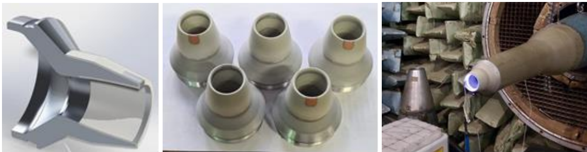
Рисунок.1 Сверхзвуковые сопла M=2 с детонационным керамическим покрытием.
